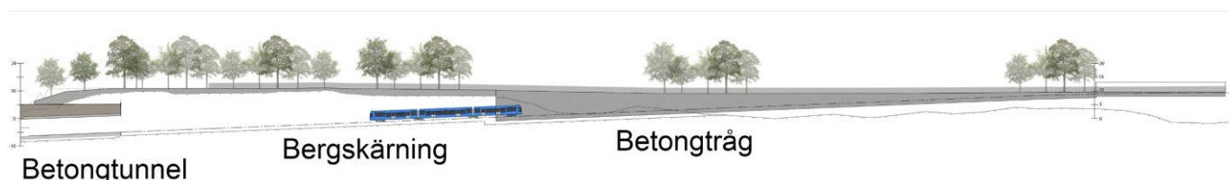
Figur 11. Längdprofil för betongtråget, bergschaktet och tunnelmynningen sett från öster. Ur gestaltningsprogrammet.
