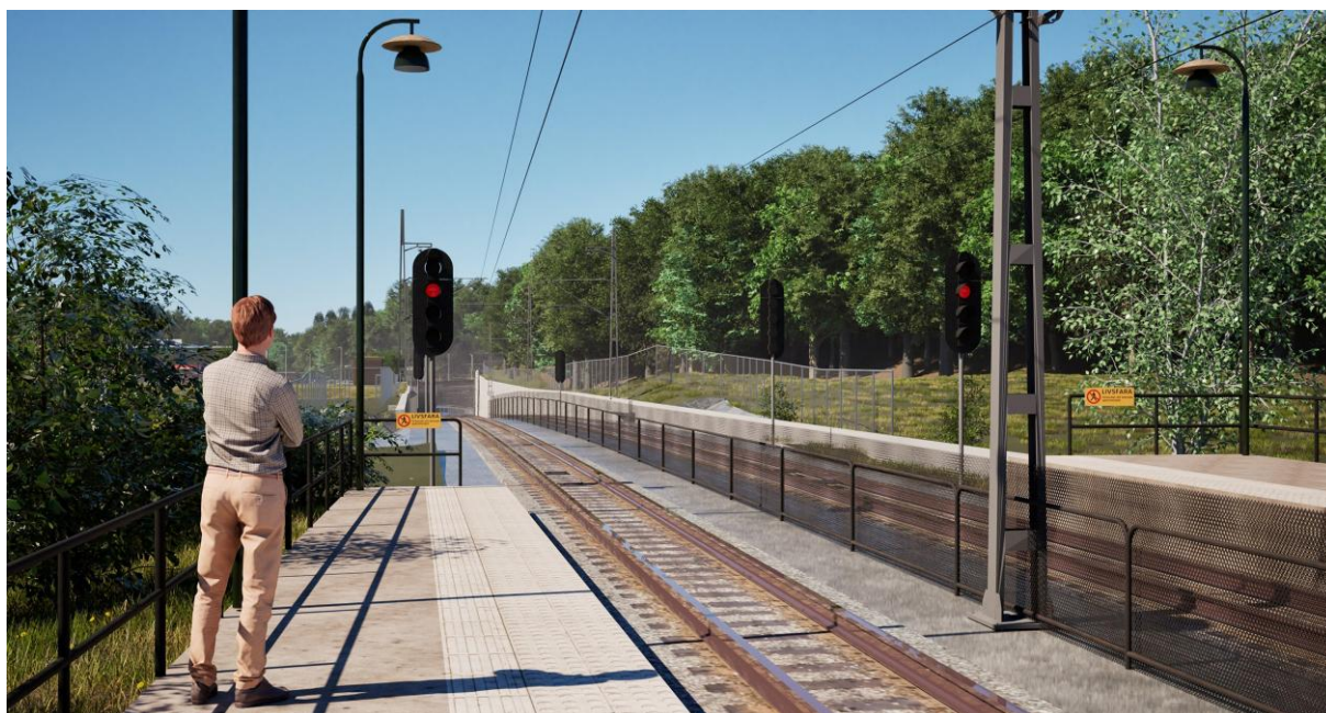
Figur 35. Visualisering ur gestaltningsprogrammet. Vy från Station Universitet vid plattformens södra ände. Spåret sjunker och väggarna blir höga mot insidan av tråget. (Observera att utformningen inte avgörs i järnvägsplanen, bilden visar endast en möjlig lösning.)
