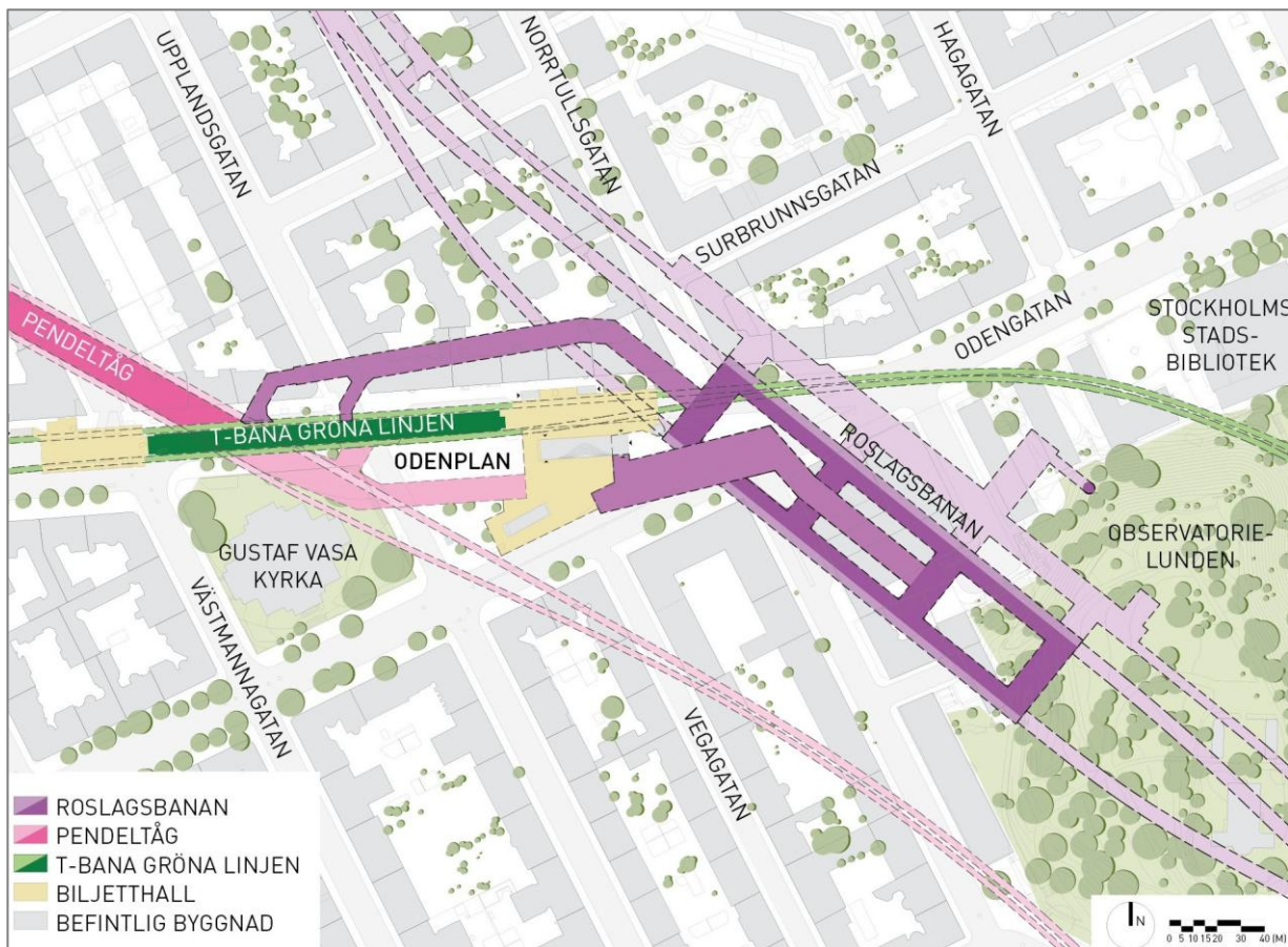
Figur 26. Situationsplan över Odenplan, som visar de underjordiska stationerna med Roslagsbanan i lila, pendeltåg (Citybanan) i rosa och tunnelbana (Gröna linjen) i grönt.
