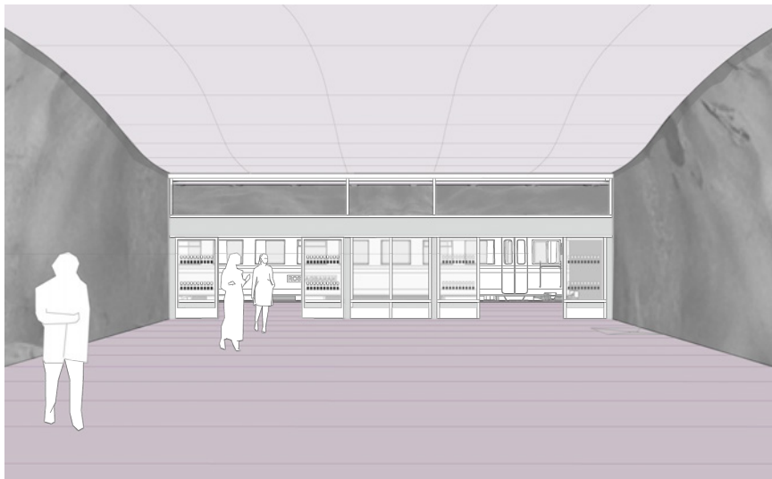
Figur 4-25 Vy från tvärpassage 3 mellan plattformshalvorna. Här finns endast ett glasparti, för att skilja plattformarna åt brandtekniskt. Undertaket gör en vågrörelse genom tvärpassagerna.
