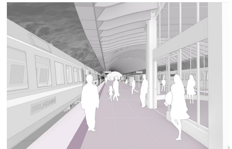
Figur 4-57 Undertak av ljudabsorberande vertikala paneler bildar ett rum för resenärerna.
