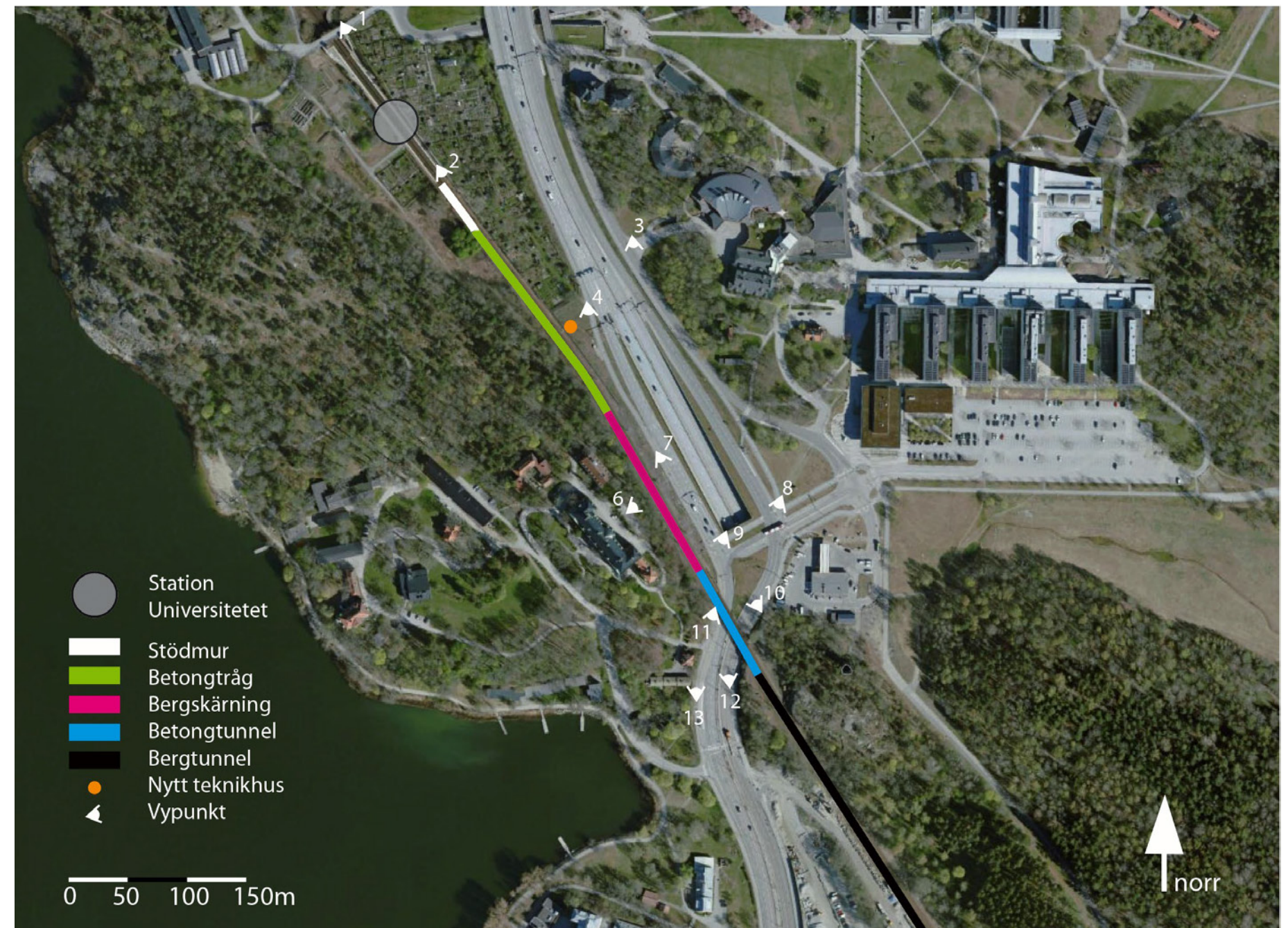
Figur 3-1 Sträckan som förändras börjar söder om Universitetets station. Innan spåret går in i betongtunneln går det i ett betongtråg och därefter med bergskärning på sidorna.
