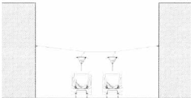
Linspänd kontaktledning mellan fasader
