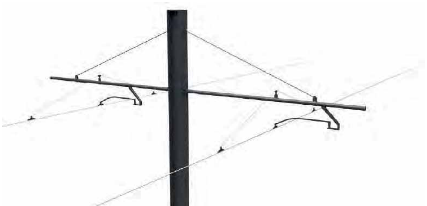
Kontaktledningsstolpe av H-balkskonstruktion med hål för fästen
