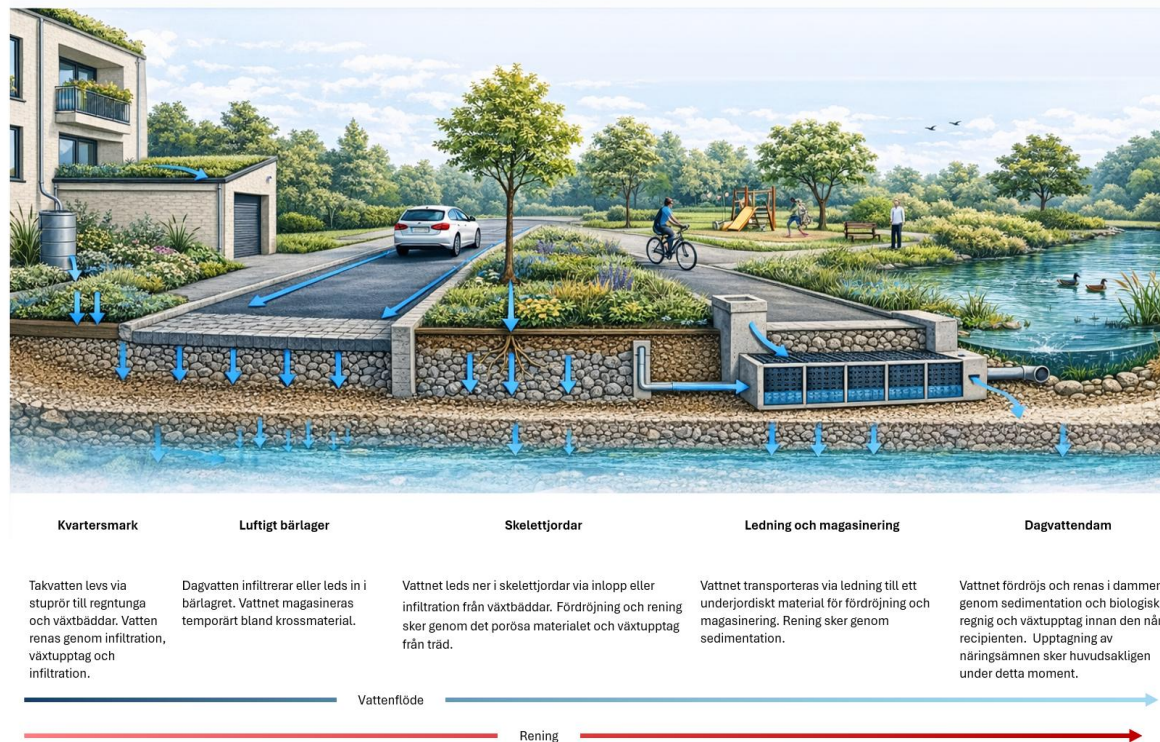
Figur 9 Schematisk principskiss över lokalt omhändertagande av dagvatten (LOD).
