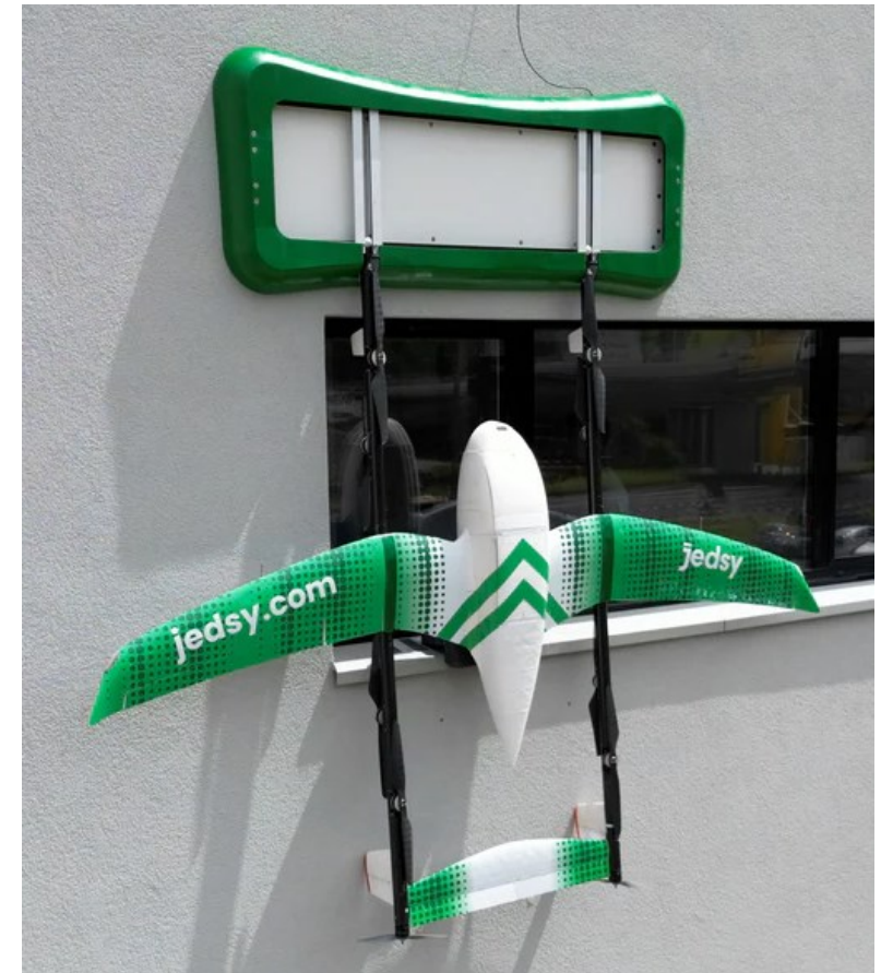
Drönare som landar/dockar direkt mot ett fönster
