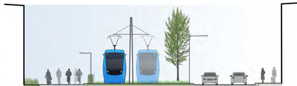
Figur 7. Principsektion för spårväg i reserverat utrymme, sidoförlagd.
