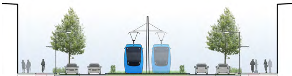
Figur 8. Principsektion för spårväg i reserverat utrymme, mittförlagd
