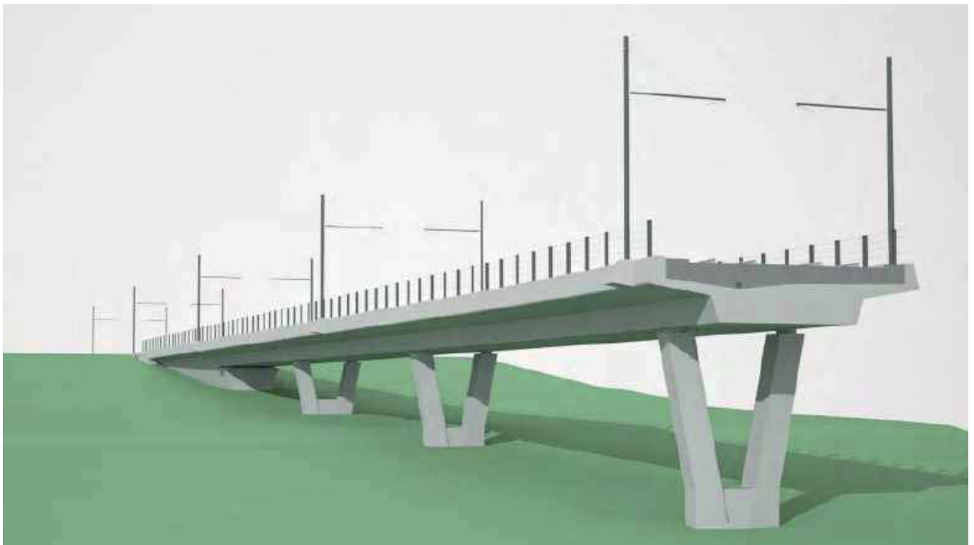
Princip för bro på stöd; perspektiv
