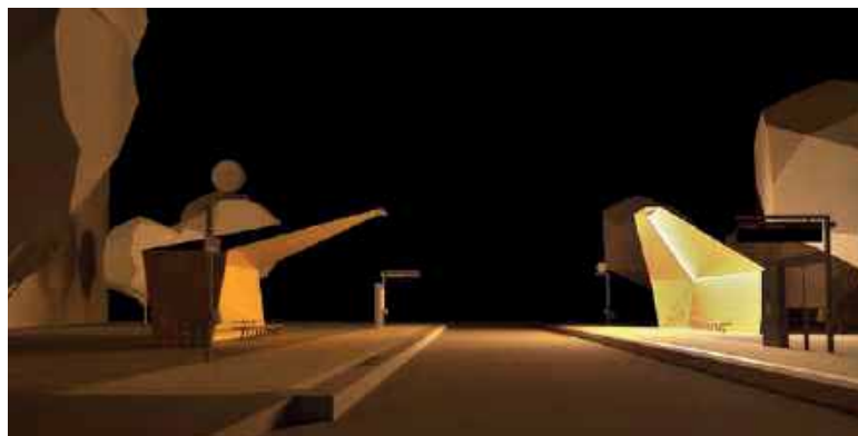
Väderskydd i plåt med perforerat mönster och belysning som ger effekt och funktionalitet (Program för torget, 2021-10-18)
