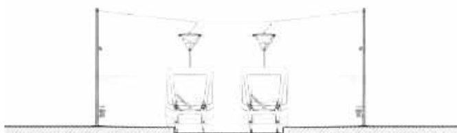
Linspänd kontaktledning på stolpar vid hållplats
