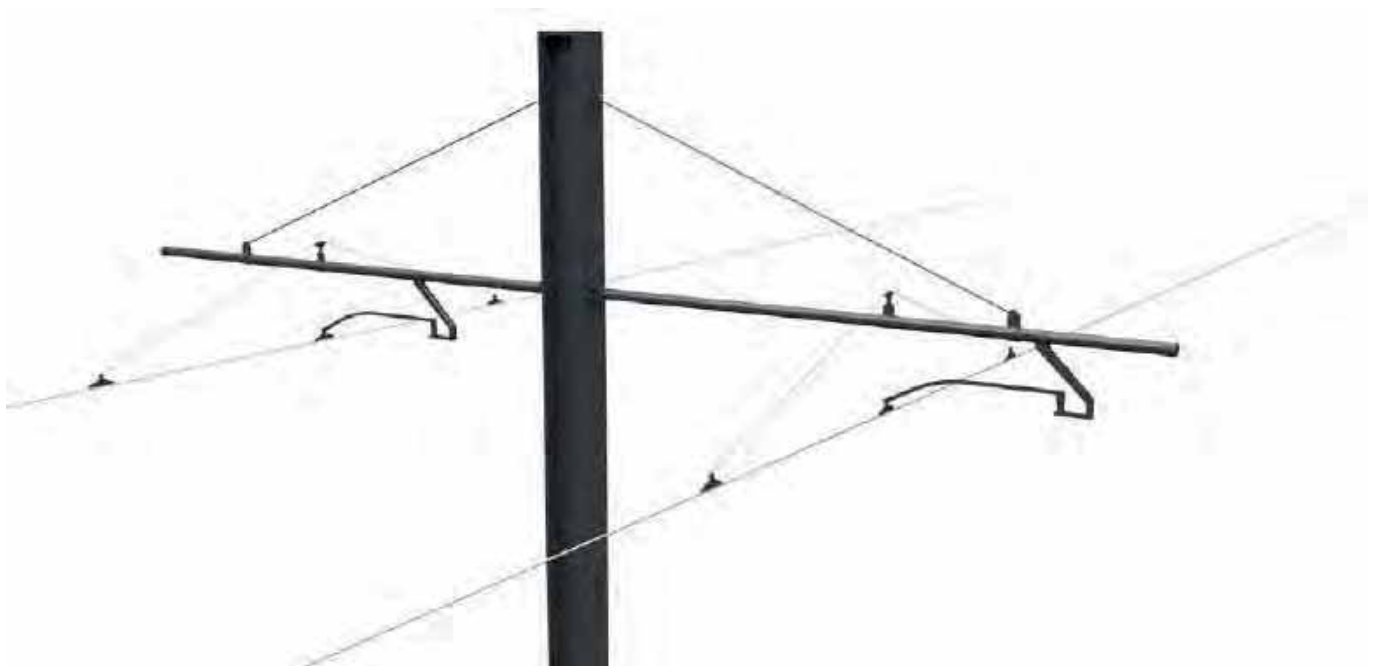
Kontaktledningsstolpe av H-balkskonstruktion med hål för fästen
