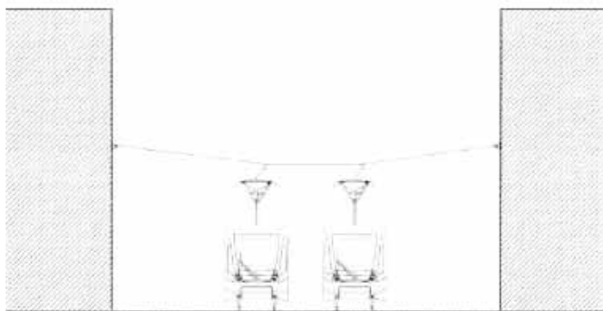
Linspänd kontaktledning mellan fasader
