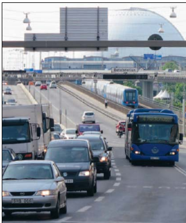
Figur 14 Visar dagens stombusslinje 4 i Stockholm, detta är dock inget BRT-system enligt definitionen då bussen inte alltid har egen körbana, på bilden kör bussen dock på egen körbana. Med fullt utbyggd BRT går bussarna på egen körbana hela vägen.
